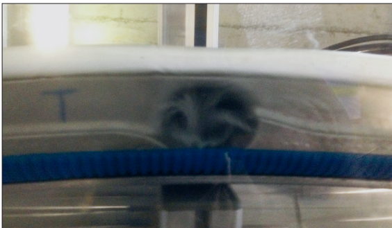
Wirbelbildung der bestehenden Geometrie anhand des Experiments am Prüfstand
