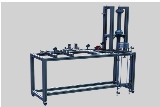
3D CAD Modell Versuchsaufbau zur Methanolsynthese aus Kohlendioxid \text{CO}_2 und Wasserstoff \text{H}_2
