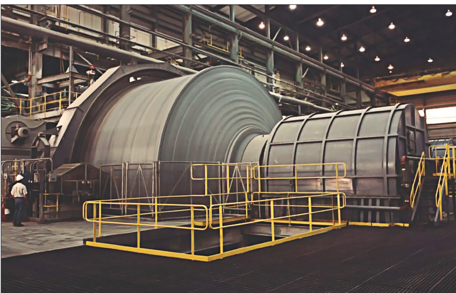
Beispiel einer Kugelmühle im Einsatz
