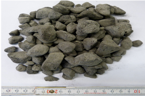
Schaumglasgranulat der Kornfraktion 11/22 mit geschlossenzelliger Kugelschaumstruktur
