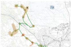
Erschliessungswirkung einer neuen Linie Wetzikon -Heusberg – Seegräben; neu erschlossene Bauzonen sind braun eingefärbt.
