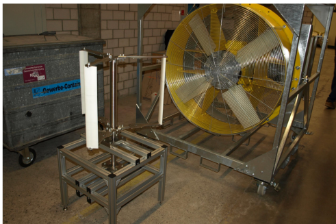
Windkanalanordnung mit der VAWT und dem Gebläse im Hintergrund.
