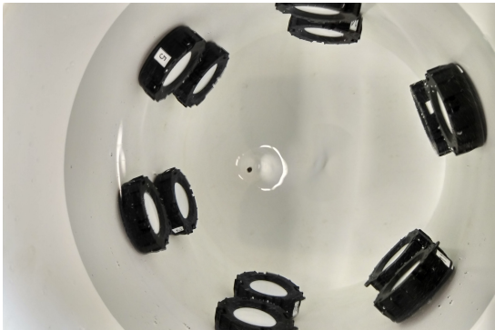
12 Passivsammler im neuen Testbehälter mit 0.5 mg/l Nitrit und 50 mg/l Nitrat Expositionsdauer: 1 Woche; Probelösung: 16 Liter
