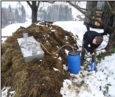
**Ausgangslage:** Mit olfaktometrischen Messungen lässt sich die Geruchsbelastung von Luft messen. Das Resultat zusammen mit dem Abluftstrom gibt Aufschluss über die Geruchsstärke der Quelle.
