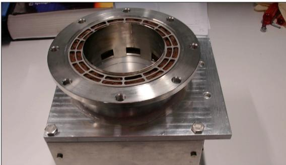
Konstruierter Wärmetauscher mit Regenerator
