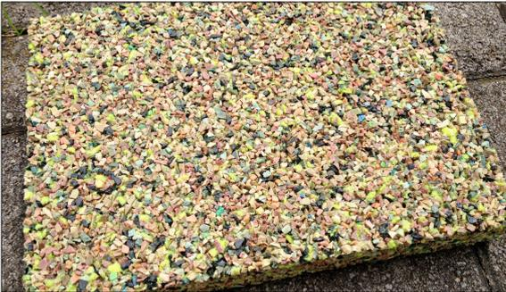
Granulatplatte aus zerkleinerten Tennisbällen, geeignet für Fallschutzplatten
