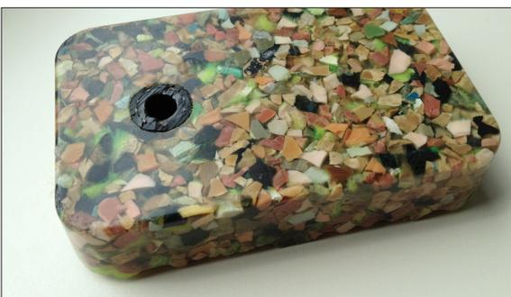
Giessversuche mit Harz, geeignet für Dekorteile
