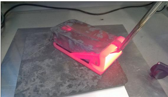
Eigenherstellung von Aluminiumnitrid. Hier die Lanze nach Erhitzung auf 1000 °C
