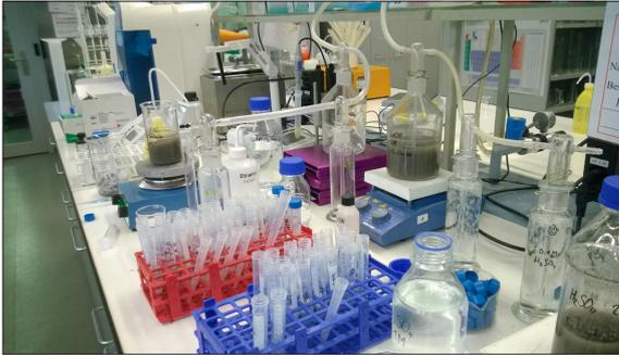
Versuchsaufbau «Impinger» zur Untersuchung des Ammoniakgehaltes
