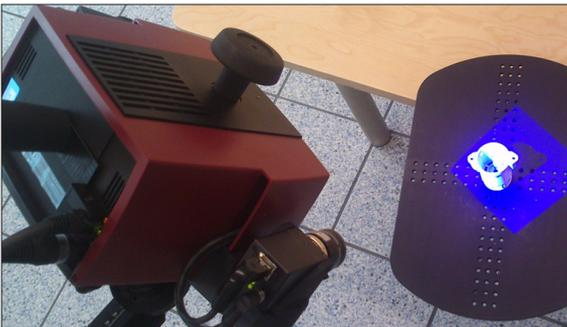
Digitalisierung der Bauteilgeometrie mittels 3-D-Scanner
