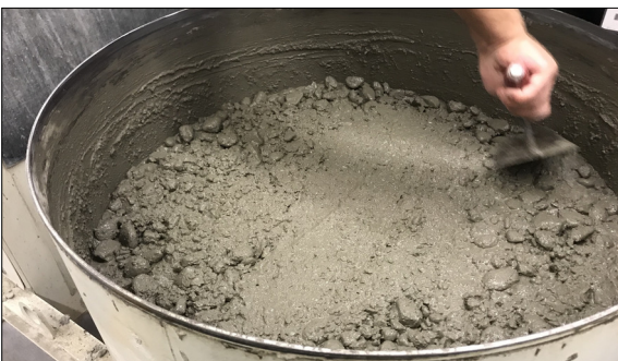
Betonherstellung mit dem recycelten Brechsand als Zuschlagstoff (BSR-1, Labor HSR) Eigene Darstellung
