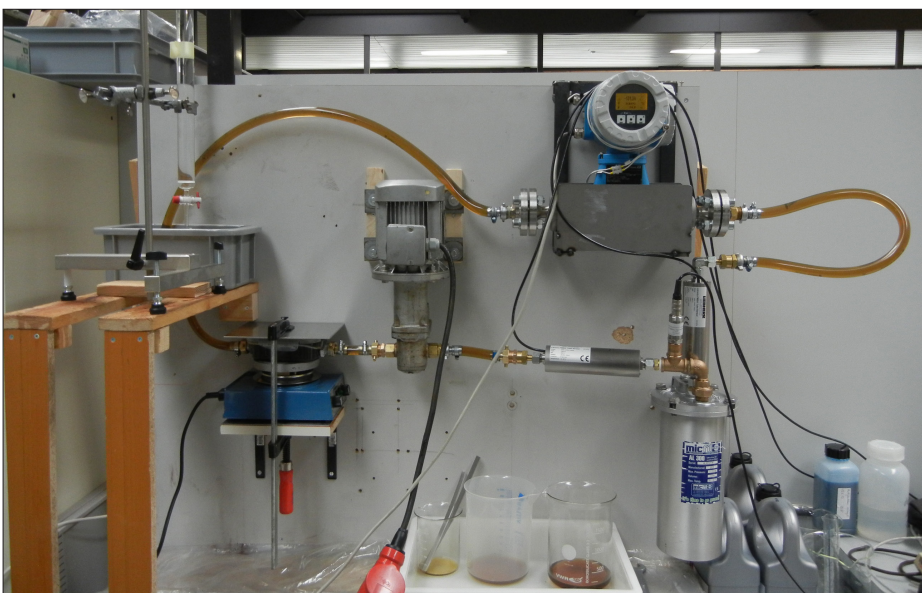
Prüfstand mit Wassereinmischung (links) und den Sensoren für die Wassergehaltsbestimmung am Filtersystem (rechts) im Umlaufbetrieb
