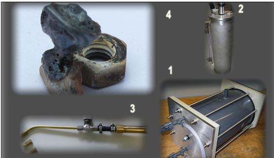
1 = Elektrolyseur; 2 = Bubbler; 3 = Brennerdüse, Flammenarrestor; 4 = Stein-Stahl-Legierung
