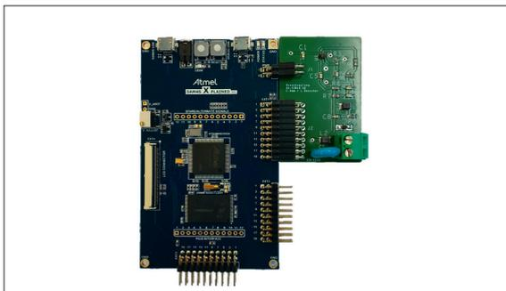
Atmel Xplained-Pro-Evaluationskit SAM4S mit Buskopplungseinheit
