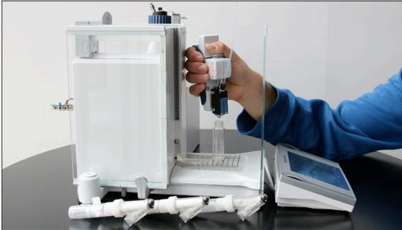
Übersicht des kompletten Dosiersystems mit erweitertem HPD, Pulverdosierköpfe und Flüssigkeitsdosiermodul
