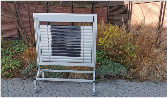
Abbildung 1: Prototyp montiert in einer mobilen Storenhalterung Eigene Darstellung
