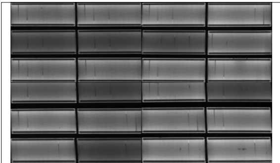
Abbildung 2: Elektrolumineszenzaufnahme der verwendeten Photovoltaikzellen Eigene Darstellung
