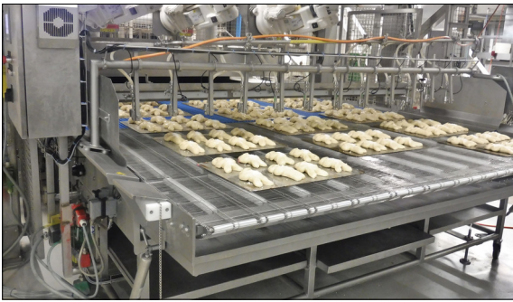
Backbleche werden bis anhin von Hand auf das Förderband gelegt, dies soll sich künftig ändern
