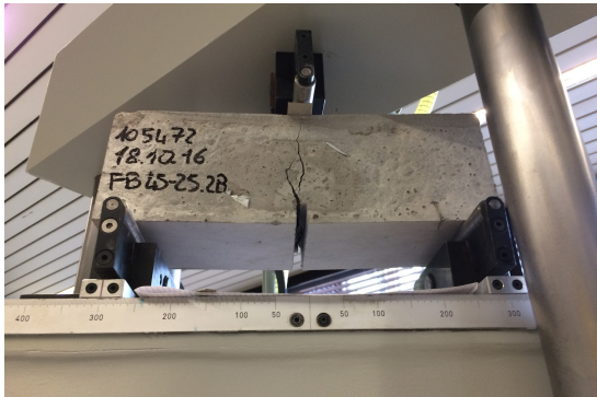
Vereinfachte Versuche an Biegebalken aus Stahlfaserbeton
