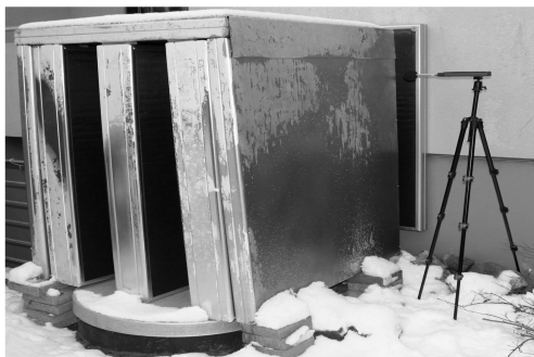
montierte Schallhaube mit Schallpegelmessgerät
