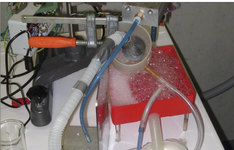
Einsatz des Messsystems unter realen Bedingungen. Die Versuchseinrichtung befindet sich im Test auf einer Waschmaschine.
