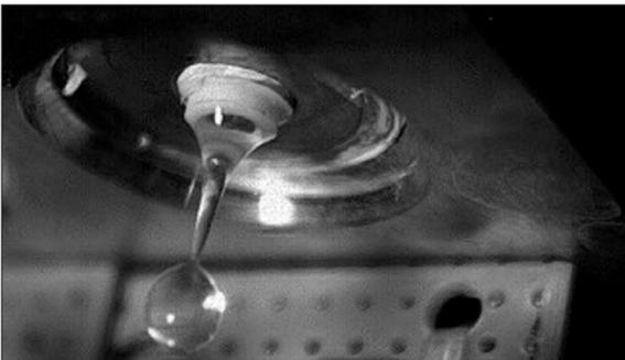
Schnappschuss eines abreisenden Tropfens mit der High-Speed-Kamera (2000 fps)
