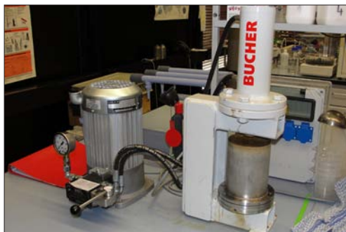
Abb. 1: Mit der hydraulischen Laborpresse (rechts) wird das freie Wasser bei einem Druck von 200 bar aus dem Schlamm entfernt.
