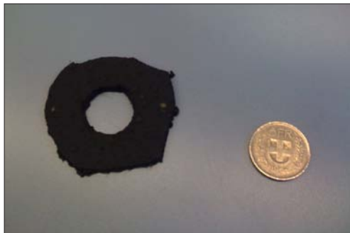
Abb. 2: Der Filterkuchen. Für die TR-Bestimmung werden jeweils der Rand und die Mitte entfernt. Es wird eine Dicke von 3,5 mm anvisiert.
