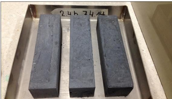
Abbildung 2: Prismen aus Zementmörtel mit einem Pflanzenkohleanteil von 40%
