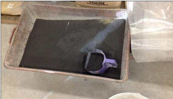
Abbildung 1: Die feine Pflanzenkohle als Ausgangsstoff für die Mörtelherstellung
