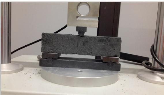
Abbildung 3: Ermittlung der Biegezugfestigkeit einer Probe mit Pflanzenkohleanteil mit einem Kraft-Weg-Prüfgerät
