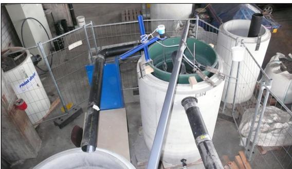
Eingebaute Testanlage zur Ermittlung des Abscheidegrades ungelöster Partikel
