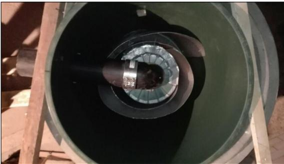
Hydrozyklon mit Prallwänden und Schlammrückführung
