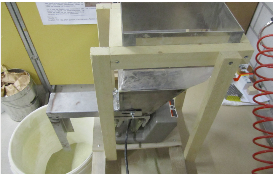
Von der Dockstation fliesst das Flockungsmittel durch einen elastischen Trichter in die Vibrationsrinne.
