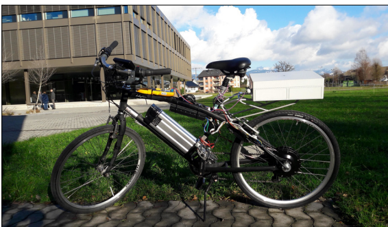
Abb 3: Das Fahrrad wurde mit den Kondensatoren in der witterungsfesten Box auf dem Gepäckträger ausgerüstet.
