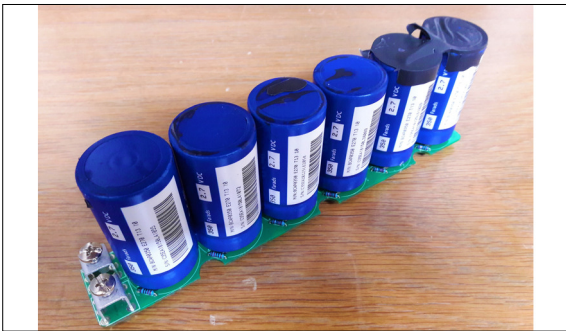
Abb. 1: Einer der insgesamt sechs Kondensatoren der Firma "Maxwell Technologies".
