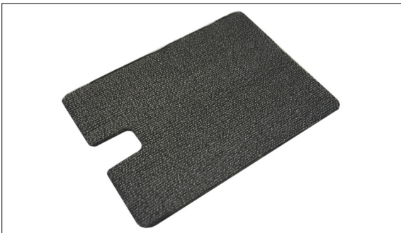
Abbildung 2: Gestickte Ablage von CF6K-PA12 Hybridgarn. Eigene Darstellung
