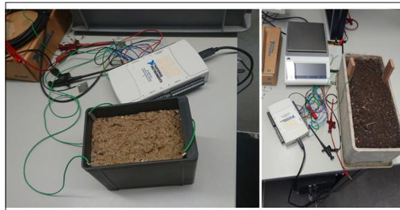
Widerstand zweier Elektroden mit unterschiedlichem Abstand gemessen über eine Stunde bei 15% Feuchtigkeit
