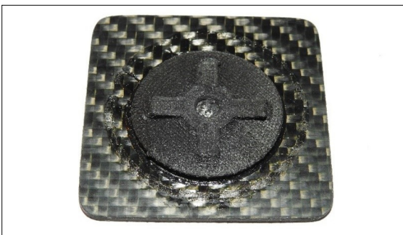
Bruchfläche eines optimierten Onsert bei einer Heissluftverbindung.
