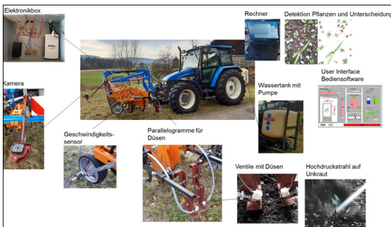
Aufbau des Funktionsmuster mit den verschiedenen Baugruppen an ein bestehendes Hackgerät. Eigene Darstellung
