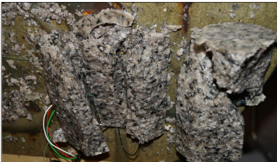
Gebrochener Prüfkörper nach dem Triaxialversuch Eigene Darstellung
