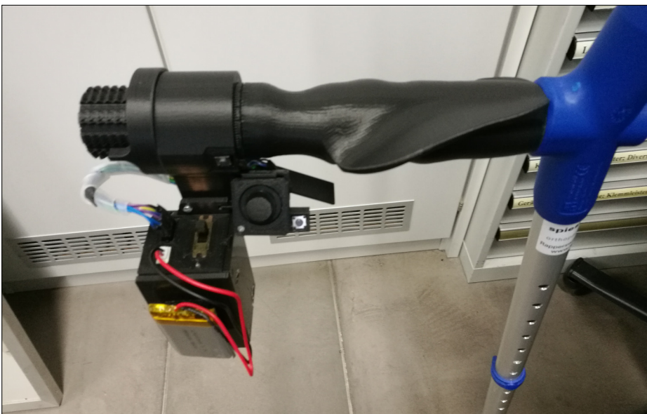
Weiterentwickeltes HMI. Ersichtlich sind zwei Taster, der Joystick und die gesamte Elektroneinheit.
