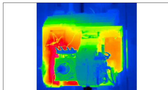
Wärmebildaufnahme vom Fräskopf Mayr Josef, 2009
