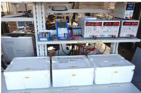
Thermoboxen und Netzteile für die künstliche Alterung
