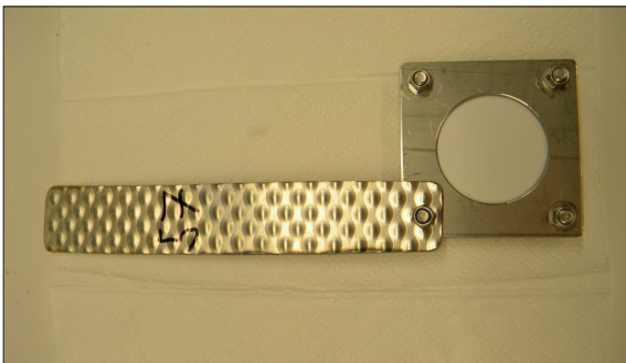
Passivsammler, mit Adsorptions- und Diffusionsschicht bestückt und angeschraubter Halterung für die Exposition
