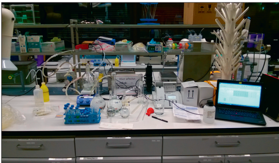
Impinger-Messverfahren zur Ammoniakbestimmung
