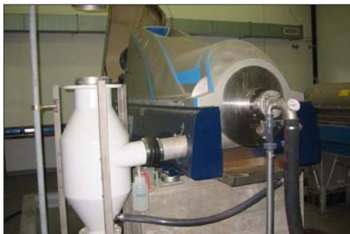
Abb. 1: Dekanter zur Entfernung des freien Wassers aus dem Klärschlamm
