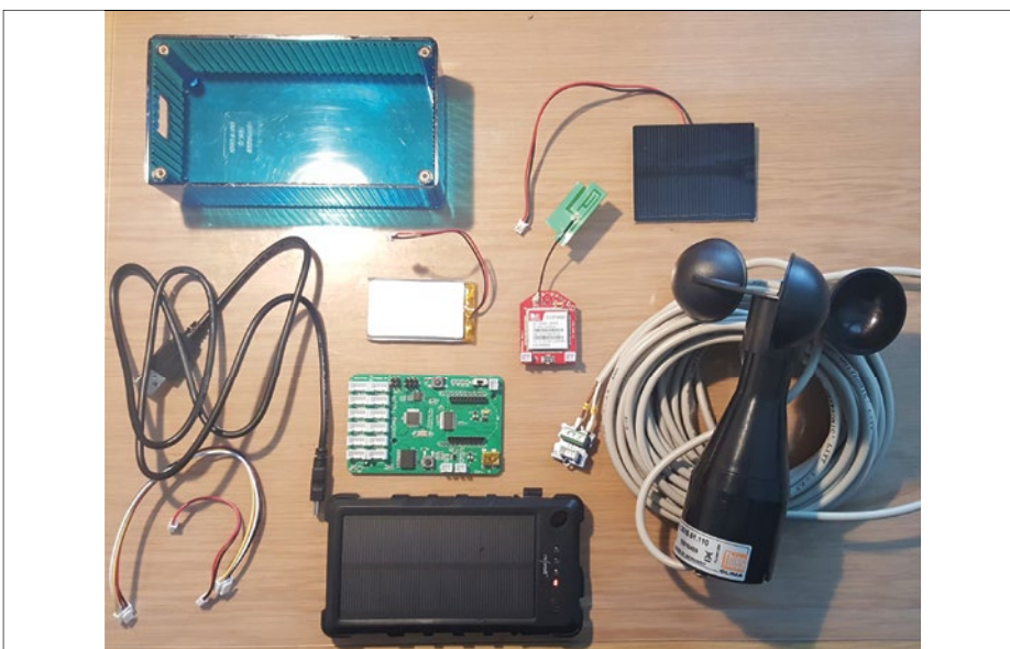
Alle Einzelteile des Gerätes: Das grüne Board ist der Micro-Controller, das rote Teil ist das GPRS-Modul und rechts ist der Anemometer abgebildet.
