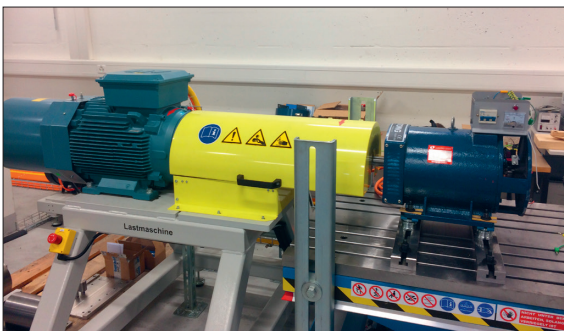
Lastmaschine links, Prüfling rechts
