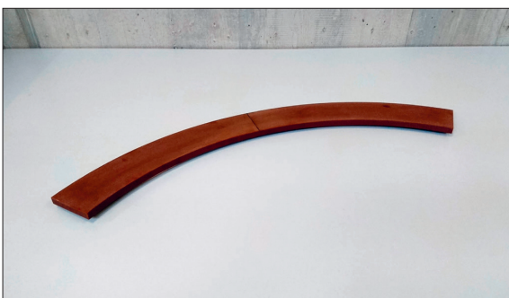
Demonstratorgeometrie des Schirmrings hergestellt aus Alternativmaterial
