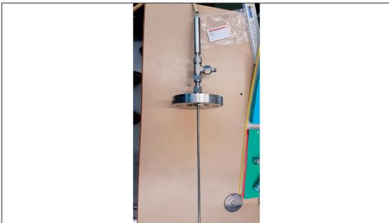
Einbau des Mantelthermoelements
