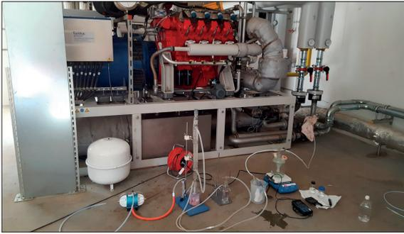
Simulation der Waschstufe mit Abgas eines mit Biogas betriebenen Blockheizkraftwerkes
