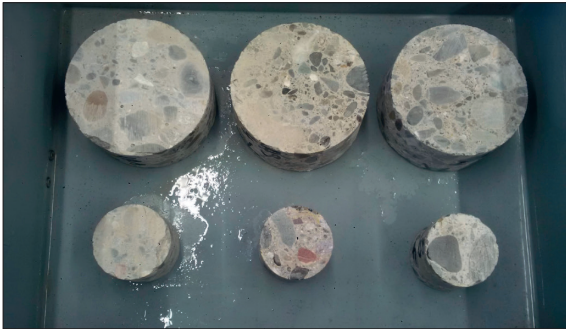
50-mm- und 100-mm-Prüfkörper aus Betonen mit unterschiedlicher Betonrezeptur
