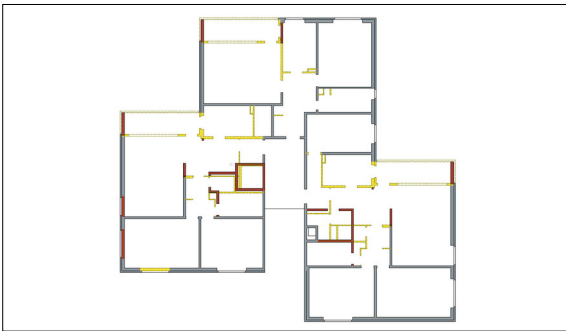
Grundriss (Revit 2019) des EG mit Darstellung aller Phasen (Bestand = grau, Abbruch = gelb und Umbau = rot) Eigene Darstellung
