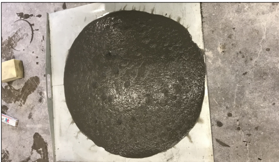
Bestrezeptur UHFB-7-1, Setzflussmass 800 mm Eigene Darstellung
