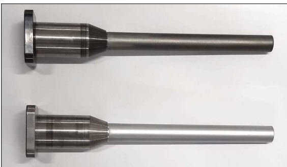
Beschichtete Werkzeugeinsätze mit unterschiedlichen Beschichtungen Eigene Darstellung
