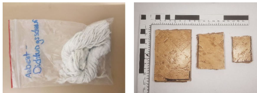
Abbildung 1: Versuchsmaterialien. Links Chrysotildichtschnur und rechts Cushion-Vinyl Boden.
