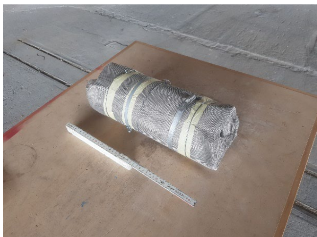
Abbildung 3: Aufgerollte und mit Draht umwickelte Bahn aus asbesthaltigem Bodenbelag ("Asbestroulade").
