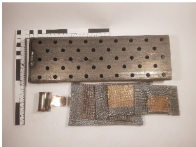
Abbildung 2: Stahlkäfig für die KVA-Versuche mit asbesthaltigem Bodenbelag und Stahlhülse mit Metallstücken zur Bestimmung der Spitzentemperaturen, denen das Material exponiert wurde.
