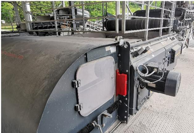
Abbildung 2: Blick auf den in der roten Staubschutzbox befindlichen "Sender" der Infrarot-Lichtschranke. Sender und Empfänger sind aussen am Wirbelstromscheider installiert und über zwei schmale Schlitz in der Gerätewand optisch miteinander verbunden.
