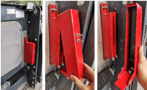
Abbildung 3: Blick auf die LED-Infrarot-Senderleiste in der geöffneten Staubschutzbox.
