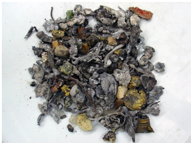
Abb. 1: Metallstücke, die aus KVA-Schlacke zurückgewonnen wurden.
